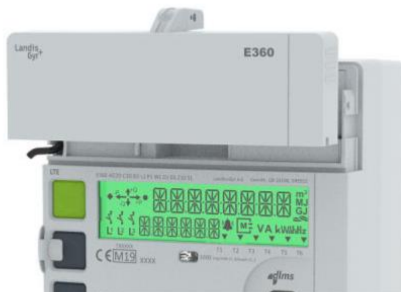
Rys. 10: Pociągnięcie do siebie pokrywy modułu komunikacji
