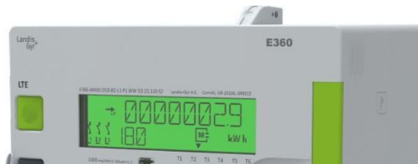
Rys. 13: Niezaplombowana pokrywa modułu komunikacji
