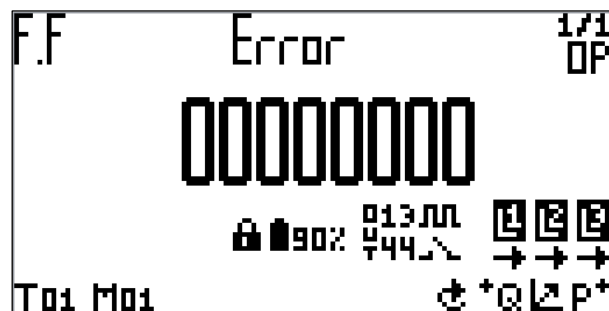
Rys. 81 Komunikat błędu w liczniku E660
