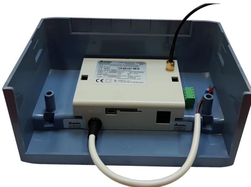
Rysunek 7 Montaż anteny wewnątrz osłony listwy zaciskowej licznika.
