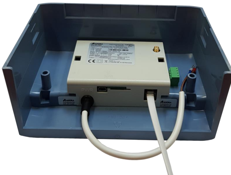
Rysunek 9 Prawidłowo podłączony przewód interfejsu licznikowego po stronie modemu.
